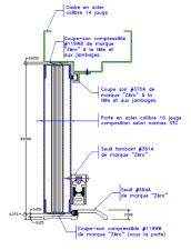
Métalec vous offre l'ensemble comprenant la porte, le cadre, le coupe-son magnétique sur l'arrêt de porte, le seuil tombant, le joint d'étanchéité au pourtour de la porte et le seuil d'aluminium.
